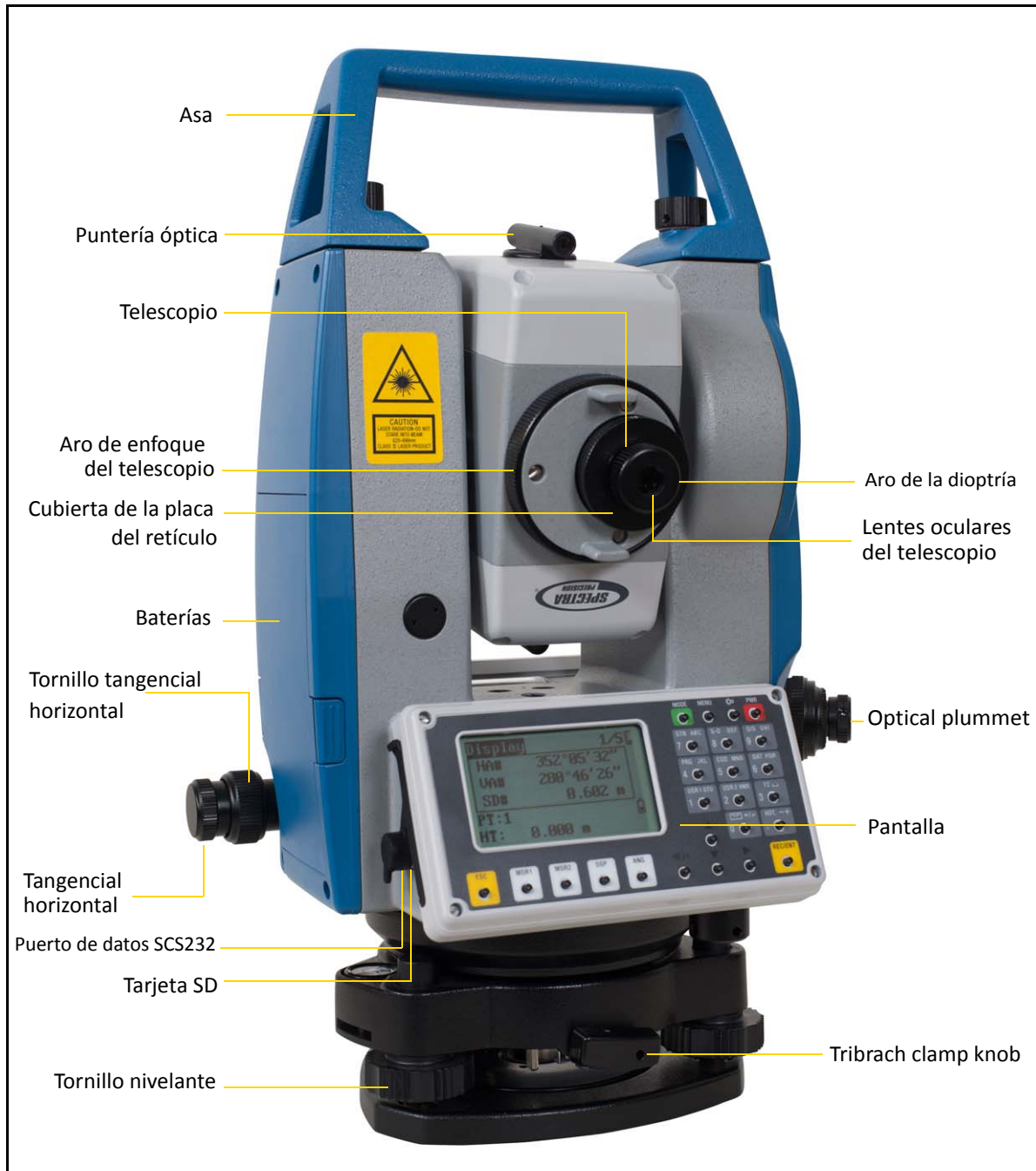
Figura 1.1 Estación total serie Focus 2: Cara derecha
