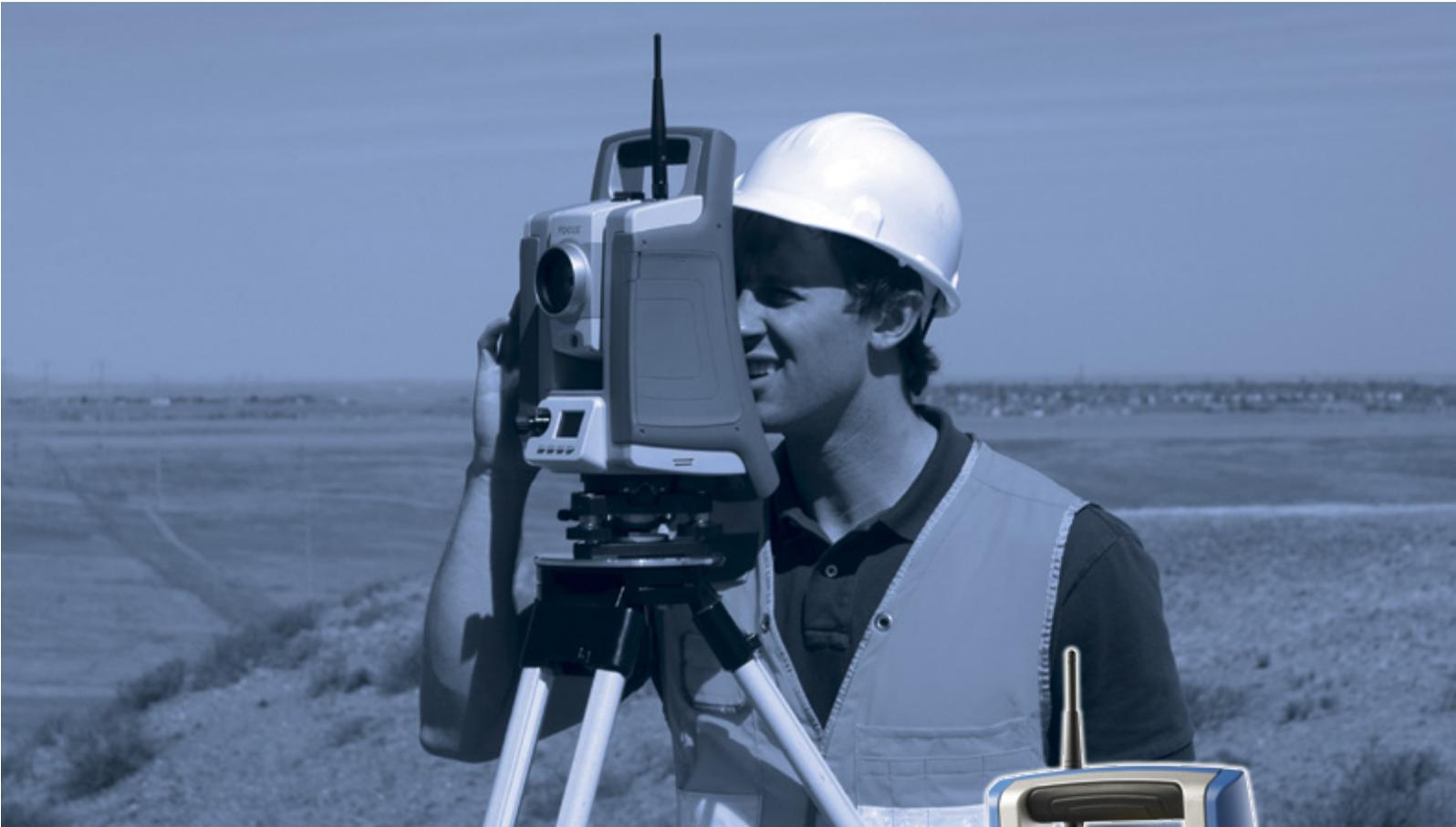
Mejore su eficiencia en el campo con una estación total robótica
